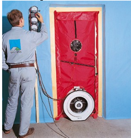
Het controleren en meten van de luchtdichtheid met de BlowerDoor.
