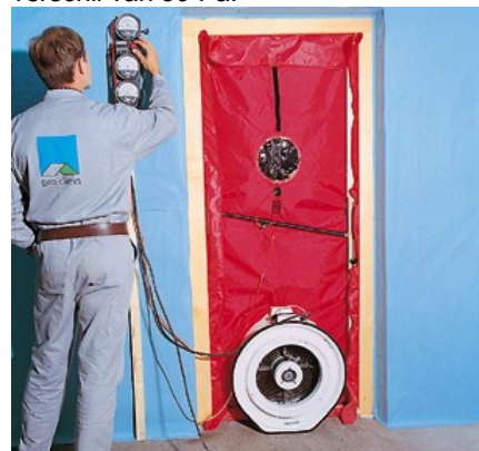
Luchtdichtingsmeting met de BlowerDoor.
