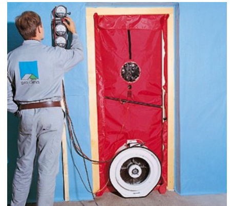
Luchtdichtingsmeting met de BlowerDoor.
